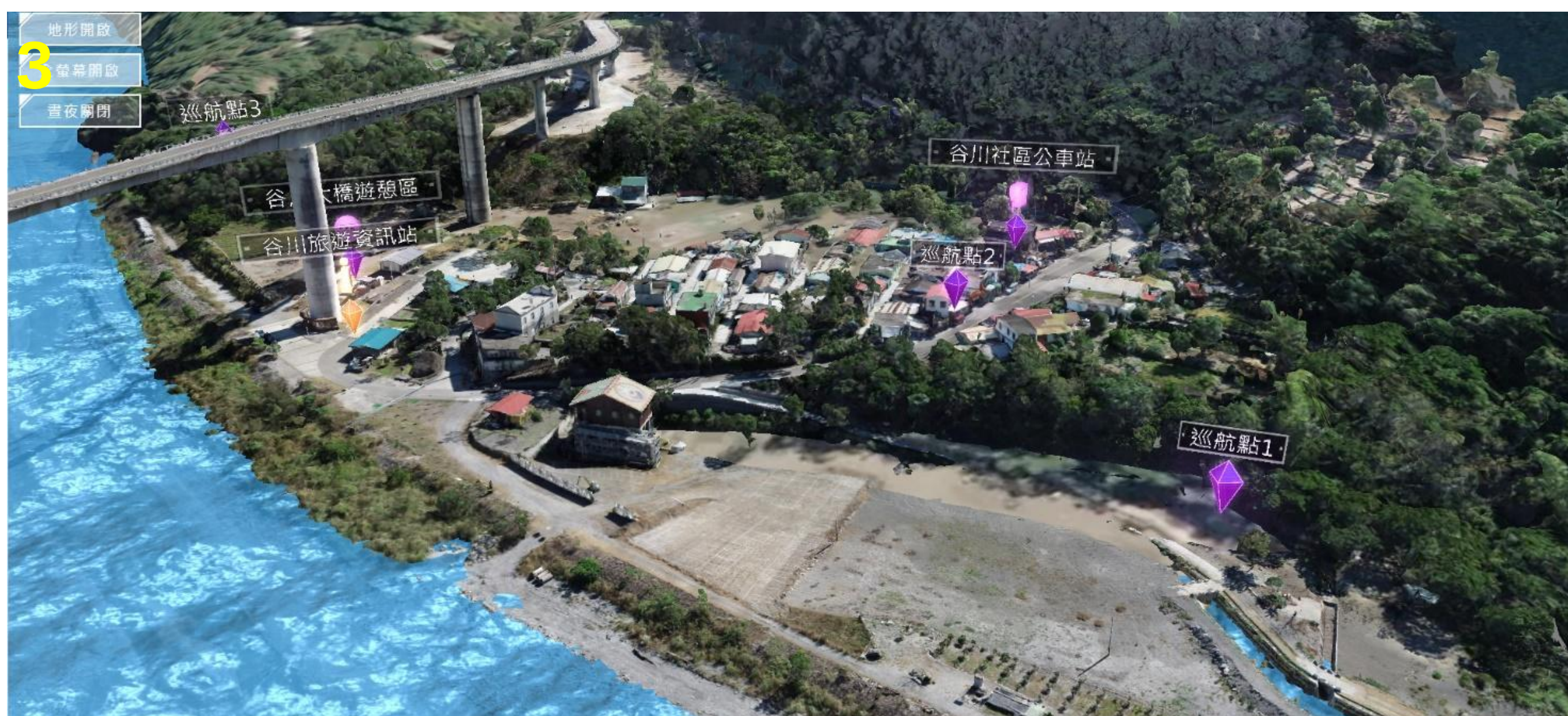
圖3 三維圖台結合水理模擬成果圖： 於三維圖台中將水理模擬成果與數位孿生模型共同演示，重現現地水位起漲狀況
