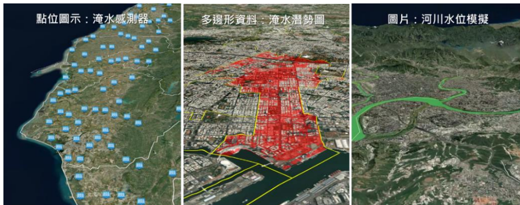
圖 2 針對淹水感測器、淹水潛勢區以及河川水位模擬圖片的 3D 展示效果
