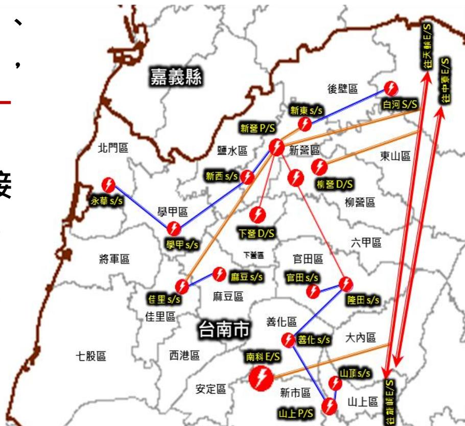
電力系統流程與供電範圍 (電壓: 345/161kV)
