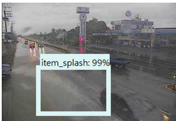
圖 5 屏東縣枋寮鄉台 1 線路段路面淹水辨識結果
