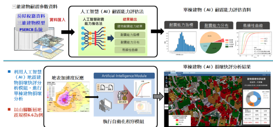
圖 2 / AI 技術輔助建物震損模擬結果
