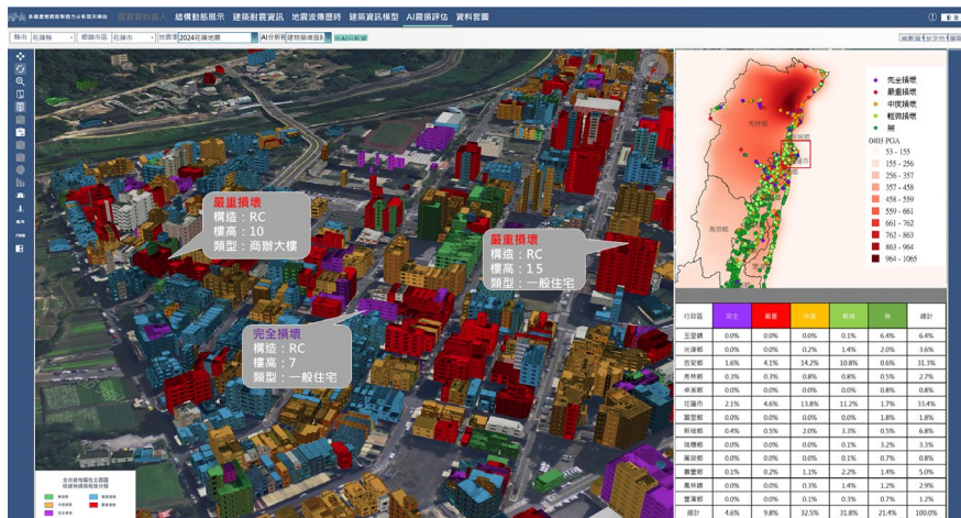
圖 3. 基於機器學習和大數據模擬 0403 花蓮地震建物震損結果展示
