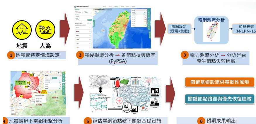
圖 4. 重要設施供電韌性風險評估流程
