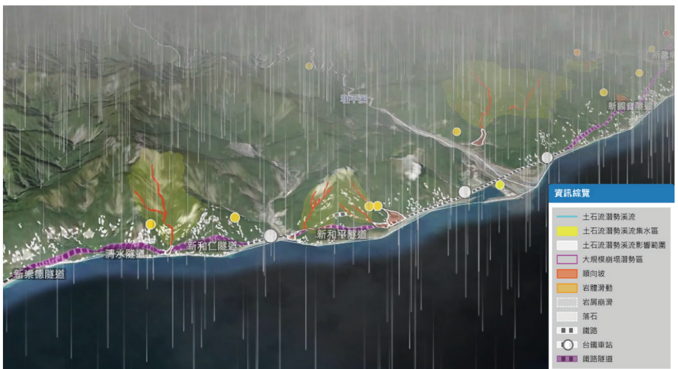
圖 2. 鐵道崩塌風險與雲雨實境視覺化整合防災預警產品
