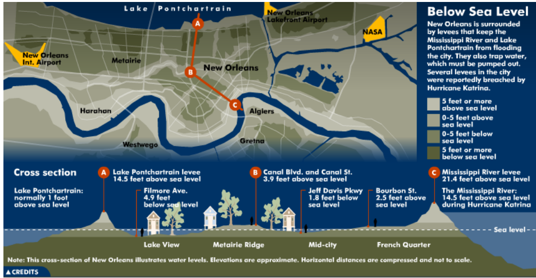
圖二 紐奧良市地形剖面與水位圖（摘自 MSNBC 網站）
