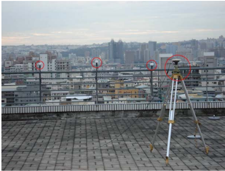
圖 3 多天線 GPS 試驗配置圖
