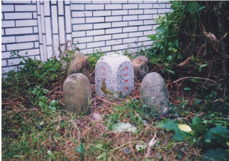
圖五 民和國小的重力基點，為中央研究院所埋設的花崗岩基點。
